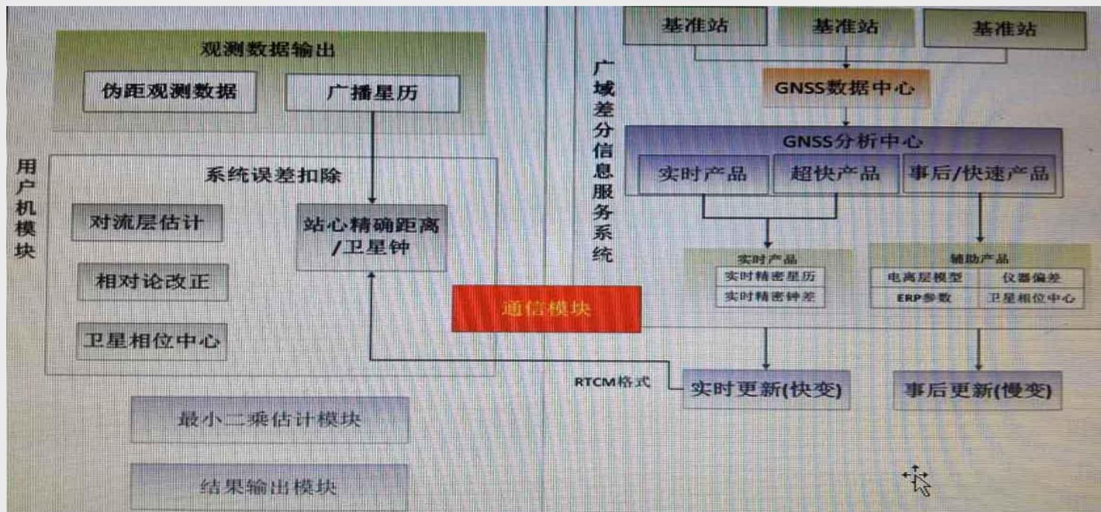
广域伪距差分技术利用伪距观测值以及广域差分产品（精密轨道和钟差产品）来进行高精度单点定位。优点：基于伪距观测数据单点定位，不存在模糊度问题，真正单历元解算；缺点：依赖实施精密轨道和钟差，对通信链路有依赖；难点：伪距噪声抑制和恶劣通信条件下改正数获取。
